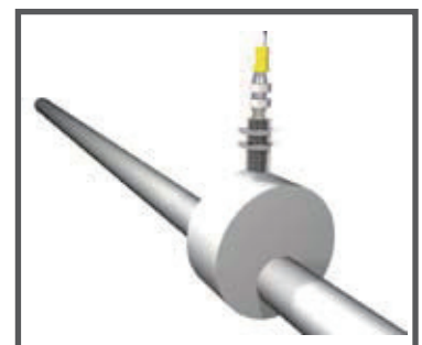
モータ回転軸の偏心測定
