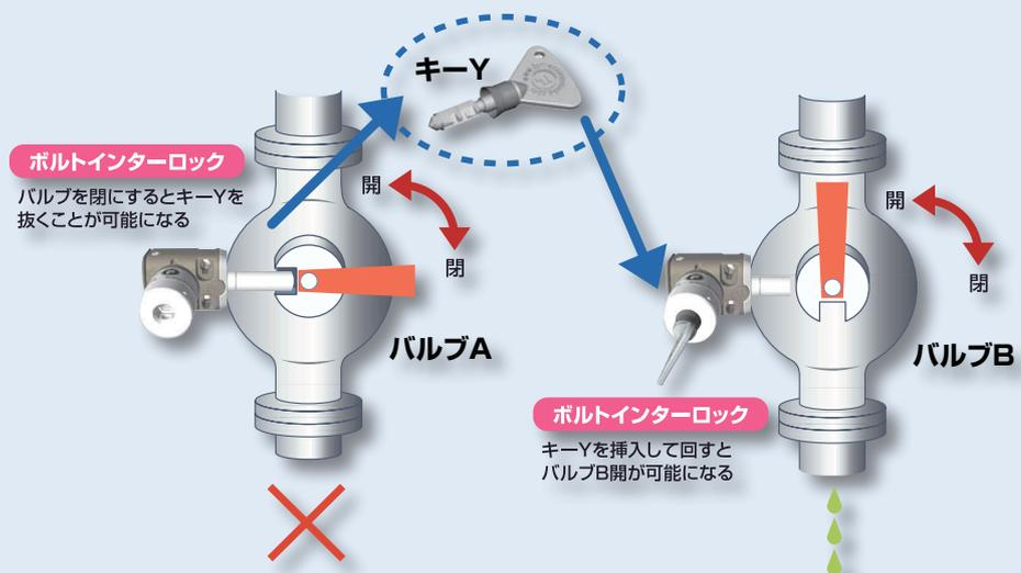
英国フォートレス社のトラップキー式インターロックスイッチ「mGard シリーズ」は、予め定義された操作シーケンスが必要な安全アプリケーションで電力遮断、キー交換、およびインターロック用に設計されたメカニカル式のインターロックです。危険な機械を点検する際に作業者の安全を確保し、万が一の事故を未然に防止するための安全スイッチです。
