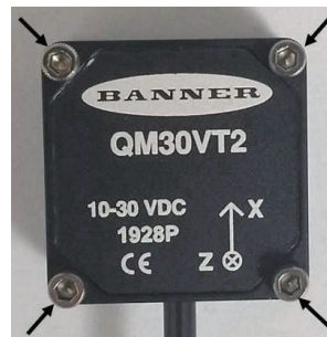
図 10. BWA-QM30-FMSS ブラケットに取り付けられた QM30VT2
