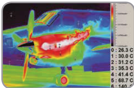
図6：プリセット0及びプリセット1データからABATERソフトウェアで作成したスーパーフレーミング処理画像
